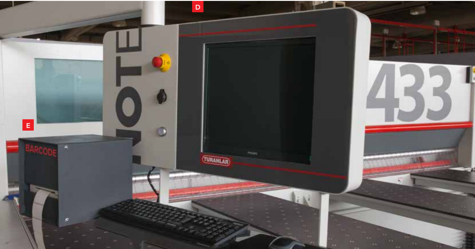
D Fonksiyonel Operatör Ekranı Functional Operator Screen
